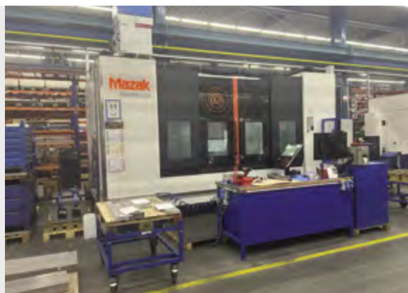
Stroje VTC 760 a VTC 800 nahradili staré obrábacie stroje španielskej výroby, ktoré bolo problematické servisovať. Oba umožňujú aj čiastočne bezobslužnú prevádzku.
