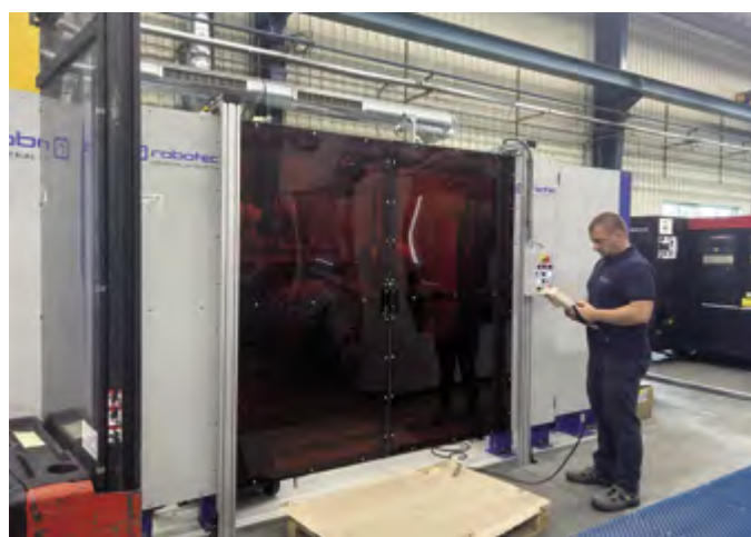
Automatizácia sa v Rademaker Slovakia týka aj zvárania. Robotizované pracovisko na TIG-ové zváranie je v prevádzke od roku 2023.
