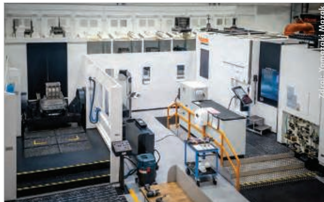
Horizontální obráběcí centrum HCN8800 s řídicím systémem Smooth G je zapojeno v automatizačním systému Palletech PHS800A.
